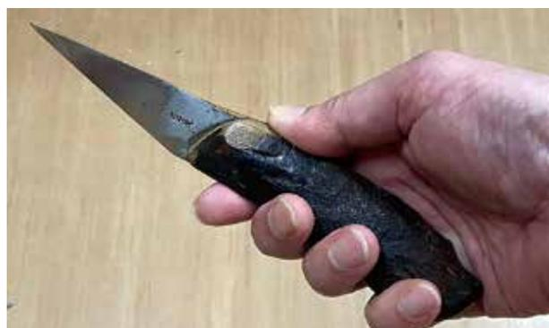
これは八戸の民芸品・八幡馬（青森県伝統工芸品）の仕上げ作業で面取りする専用のナイフ。20数年前、先輩から教わって作ったものを今も使っています。元の切り出し小刀と比べると違いがわかると思いますが、作業面が広いいため刃幅もそれに合わせて広めに研ぎ出しています。持ち手は木材を組み合わせて自分の手の大きさに合うように、曲がりをつけています。小指でしっかり握れるように切り込みを、逆に親指でしっかり力が伝わるように膨らみをつけています。
